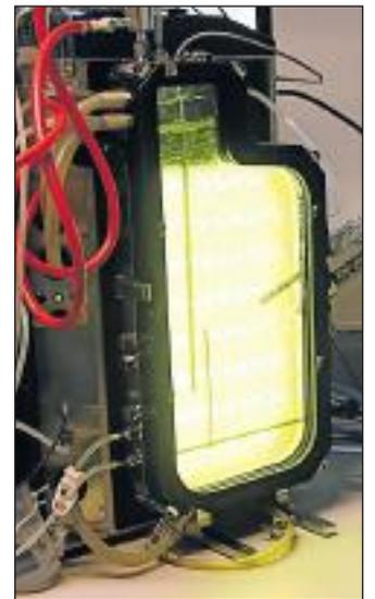
**Unter optimalen Bedingungen: In einem 1,8-Liter-Bioreaktor wird das Mikroplastik von Enzymen zerlegt.** FOTO: KLEIN/FREI
