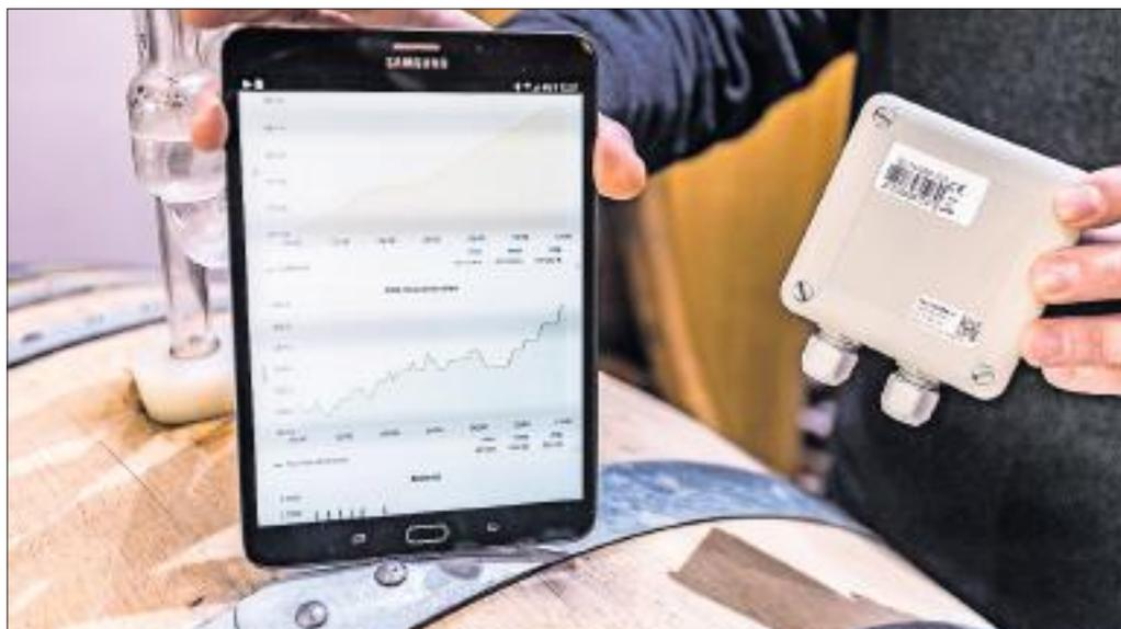
**Praktische Anwendung von LoRaWan: Sensoren messen den CO<sub>2</sub>-Gehalt in einem Gärkeller. Die Daten werden per Funk übermittelt und ermöglichen eine Fernüberwachung. Im Weinbau wird das Netz tatsächlich schon eingesetzt.**
