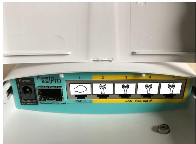
Abbildung 9: Geöffnetes Routerboard mit Anschlüssen
